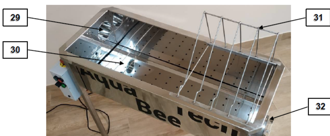
Rys. 4 Urządzenie ABT OM-3 przygotowane do odsklepiania ramek z plastrami pszczelimi, widok od góry
