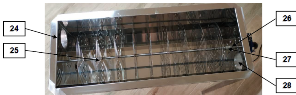
Rys. 3 Urządzenie ABT OM-3 przygotowane do osuszania miodu, widok wnętrza zbiornika głównego
